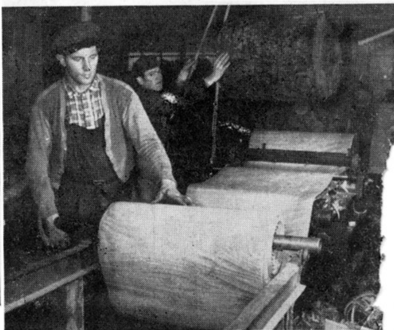
Her er en Stamme netop ankommet fra en dansk Skov, og paa Skælemaskinen forvandles den til millimetertyndt Finér.
