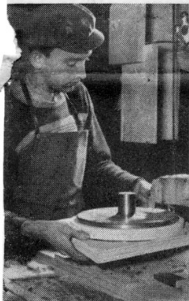
Carl Eriksen laver her de cirkelrunde Bunde og Laag til Fustagerne, der derefter forsynes med en speciel Lukkeanordning konstrueret af Fabrikant Rob. Jensen.
